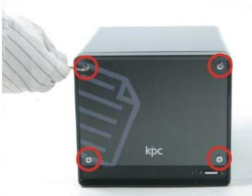
Entfernen Sie die vier Schrauben mit dem Sechskant-schlüssel, damit die Frontblende demontiert werden kann.
