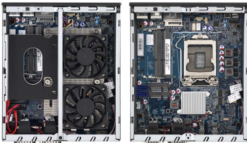
Ansicht von oben ohne Gehäusedeckel (mit und ohne Laufwerkshalterung und Kühlsystem)
