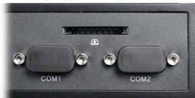
**COM-Port Pin 9 Konfiguration:** Pin 9 des COM-Ports ist ein multifunktionaler Anschluss (auf dem Foto mit rotem Kreis markiert). Mit dem Mainboard-Jumper JP2 lässt sich konfigurieren, ob Pin 9 als "Ring Indicator" (RI) geschaltet ist oder eine externe Spannungsversorgung von 5V bzw. 12V bietet (jeder COM-Port ist einzeln konfigurierbar)
