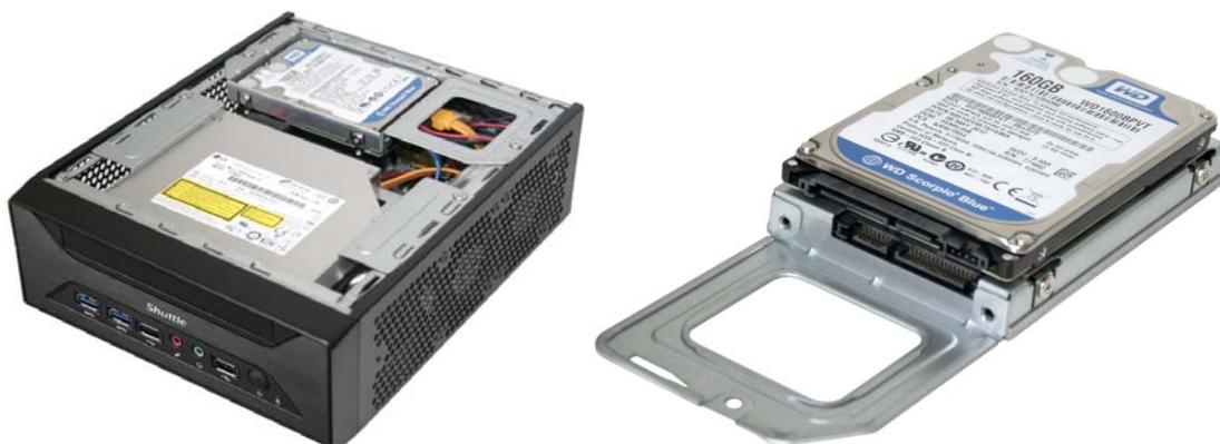
Das XH81 unterstützt ein optisches Laufwerk im 5,25" Slimline-Format und zwei 2,5"-Laufwerke (z.B. Festplatte und SSD). Für das zweite 2,5"-Laufwerk werden jedoch noch ein weiteres SATA-Kabel und vier passende Schrauben benötigt, was nicht im Lieferumfang enthalten ist.
