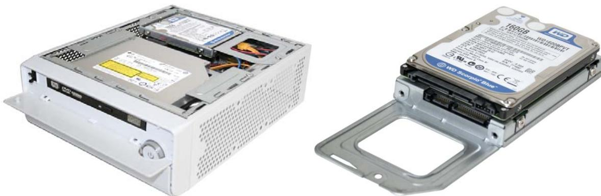
Das XH81V unterstützt ein optisches Laufwerk im 5,25" Slimline-Format und zwei 2,5"-Laufwerke (z.B. Festplatte und SSD). Für das zweite 2,5"-Laufwerk werden jedoch noch ein weiteres SATA-Kabel und vier passende Schrauben benötigt, was nicht im Lieferumfang enthalten ist.
