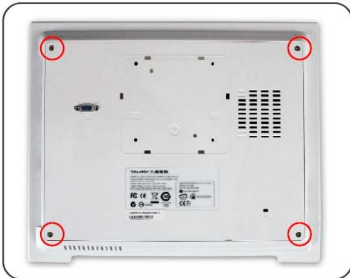
**(3)** Entfernen Sie die 4 Kreuzschlitzschrauben des Gehäusedeckels.
