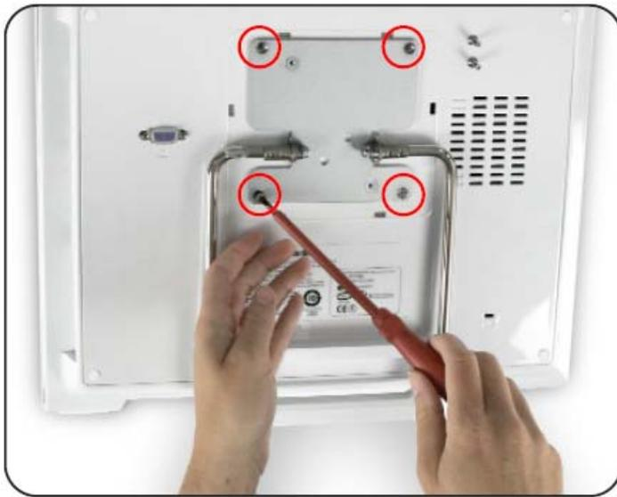
**(2)** Lösen Sie 4 Kreuzschlitzschrauben, um die Ständer-Mechanik zu entfernen.
