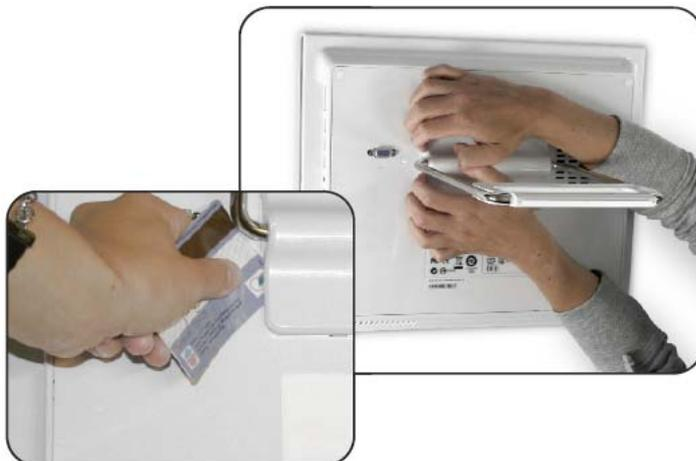
**(1)** Trennen Sie das Gerät vom Stromnetz und legen Sie es mit dem Display nach unten auf eine weiche Unterlage und klappen Sie den Ständer senkrecht nach oben. Zunächst wird der Deckel mit dem Shuttle-Logo entfernt, welcher mit 6 Haken eingerastet ist. Pressen Sie dazu vorsichtig mit den Fingerkuppen seitlich gegen den Shuttle-Deckel um ihn zu lösen. Alternativ lässt sich der Deckel auch aushebeln, indem man eine Plastikkarte von der Bügelöffnung an abwärts unter die Abdeckung gleiten lässt.
