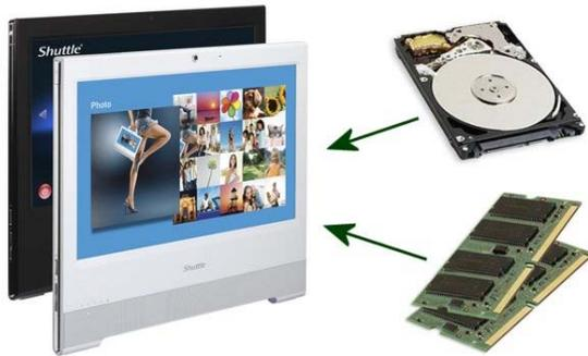
In der Barebone-Version wird das Gerät ohne Speicher und Festplatte ausgeliefert. Bitte beachten Sie die Hinweise in dieser Anleitung, wenn Sie Komponenten bestücken oder austauschen möchten. Das Gerät verfügt über zwei SO-DIMM-Steckplätze für max. 2x 1GB DDR2-667/800 und einen 2,5-Zoll-Schacht für eine Serial-ATA-Festplatte.
