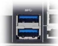
Das Shuttle XPC Barebone SH87R6 bietet vier USB 3.0 Anschlüsse (2x vorne und 2x hinten) neben sechs weiteren USB 2.0 Anschlüssen. USB 3.0 kann Daten mit einer Geschwindigkeit von bis zu 5.0 Gbit/s (640 Mbytes/s) übertragen, was der zehnfachen Geschwindigkeit von USB 2.0 entspricht.
