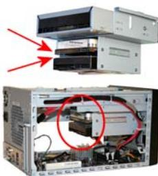
**Unterstützt ein optisches Laufwerk und zwei Festplatten**
