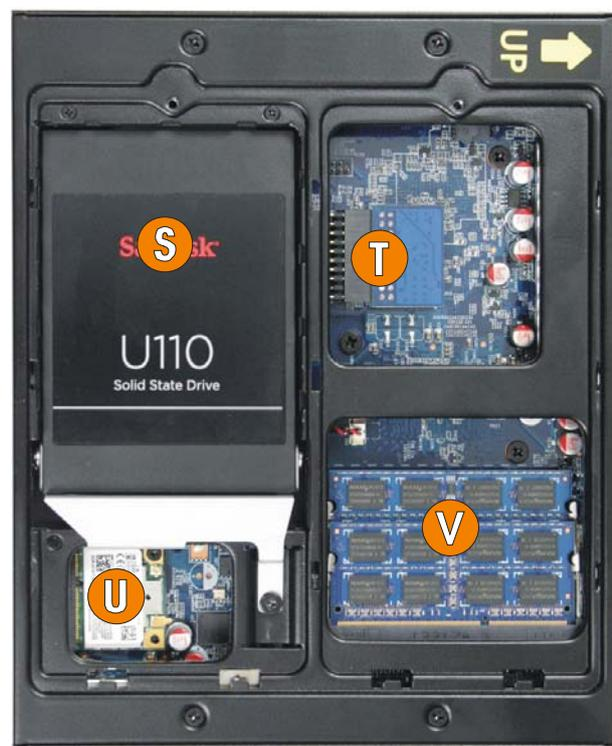
\*) Das WLAN-Modul gehört in Form einer Mini-PCIe-Steckkarte zum Lieferumfang des Barebones. Andere Komponenten wie Festplatte, SSD, Speicher, eine weitere Steckkarte oder ein TPM-Modul, sind nicht enthalten.
