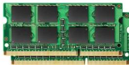
Bis zu zwei DDR4-2400/2666 SO-DIMM Speichermodule mit jeweils max. 32 GB
