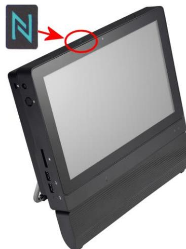
Der Aufkleber mit dem NFC-Symbol markiert die Position der NFC-Antenne beim Shuttle XPC all-in-one P20U.
