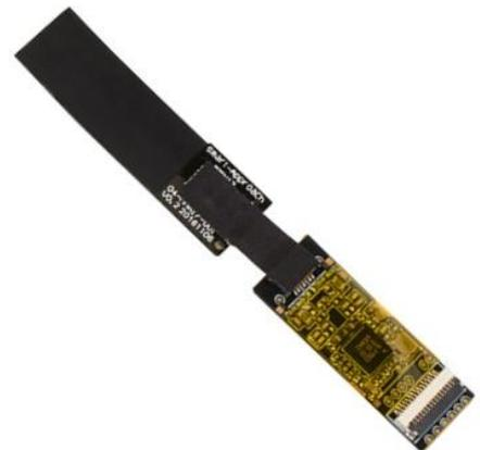
4. Befestigen Sie das NFC-Modul wie abgebildet. Öffnen Sie die Verriegelung des Anschlusses durch Anheben, führen Sie das FFC-Folienkabel hinein (blaue Markierung nach oben) und schließen Sie die Verriegelung wieder.
