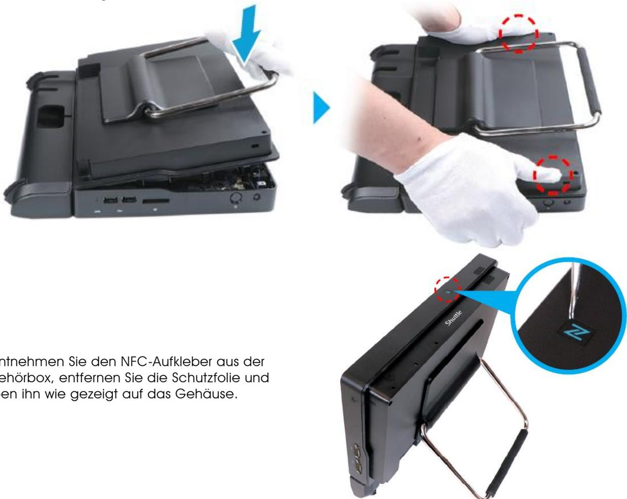
6. Entnehmen Sie den NFC-Aufkleber aus der Zubehörbox, entfernen Sie die Schutzfolie und kleben ihn wie gezeigt auf das Gehäuse.
