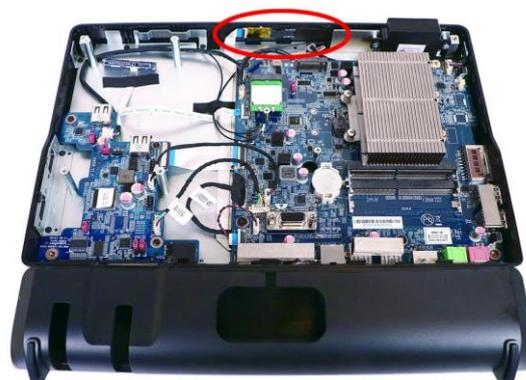
Shuttle XPC all-in-one P20U mit geöffnetem Gehäuse. Die Markierung zeigt die Position des eingebauten NFC-Moduls.
