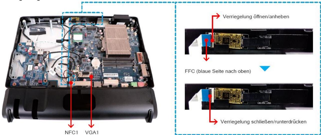
5. Verbinden Sie das D-Sub/VGA-Kabel wieder mit dem Anschluss "VGA1" und schrauben Sie die Gehäuseabdeckung wieder fest.
