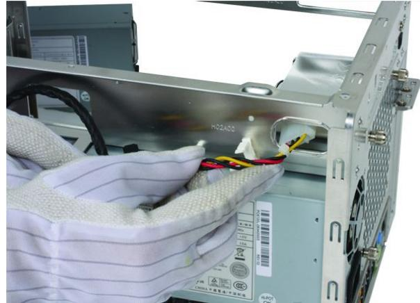
② Führen Sie das Stromkabel für die Festplatten durch die Durchführung im Chassis (wie auf dem Bild gezeigt) und verbinden es mit den Laufwerken.
