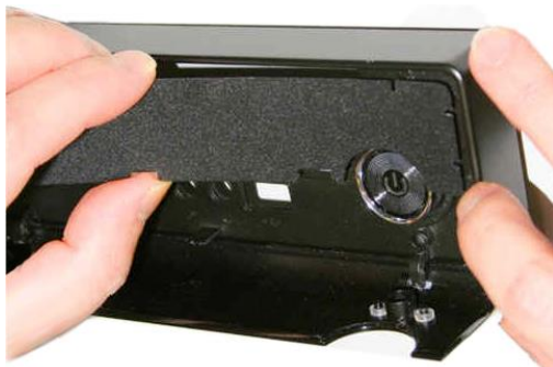
Installation des selbstklebenden Mylars
