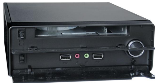
Der PC mit geöffneten Abdeckklappen. Der obere Schacht bleibt leer.
