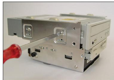
3. Die Schrauben auf einer Ebene befestigen, um sicherzustellen, daß sich das FDD-/CD-ROM-Laufwerk auf derselben Höhe wie die Gerätevorderseite befindet.
