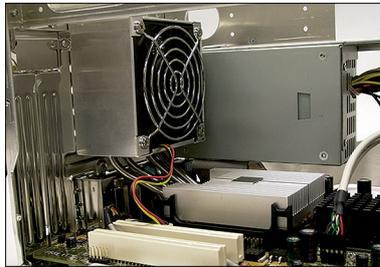
8. Das I.C.E.-Modul oben auf den Montagerahmen setzen und dann die Halteklammer des I.C.E.-Moduls auf dem Kühlkörper anbringen.
