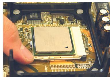
**Hinweis:** Der Pin 1 der CPU-Halterung muß an der CPU-Eckmarkierung ausgerichtet werden, da sonst möglicherweise einige Pins der CPU beschädigt werden könnten
