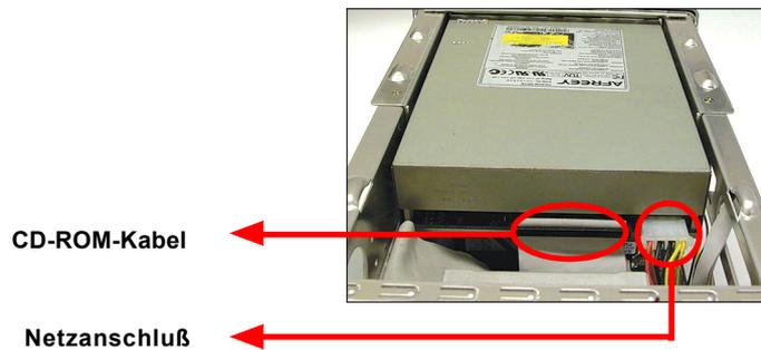
**Hinweis:** Um Platz zu sparen und den Aufbau möglichst sauber durchzuführen ist empfohlen, dass Datenkabel des CDROM-Laufwerks ein wenig zu falten und es mit den mitgelieferten Kabelbindern zu fixieren.
